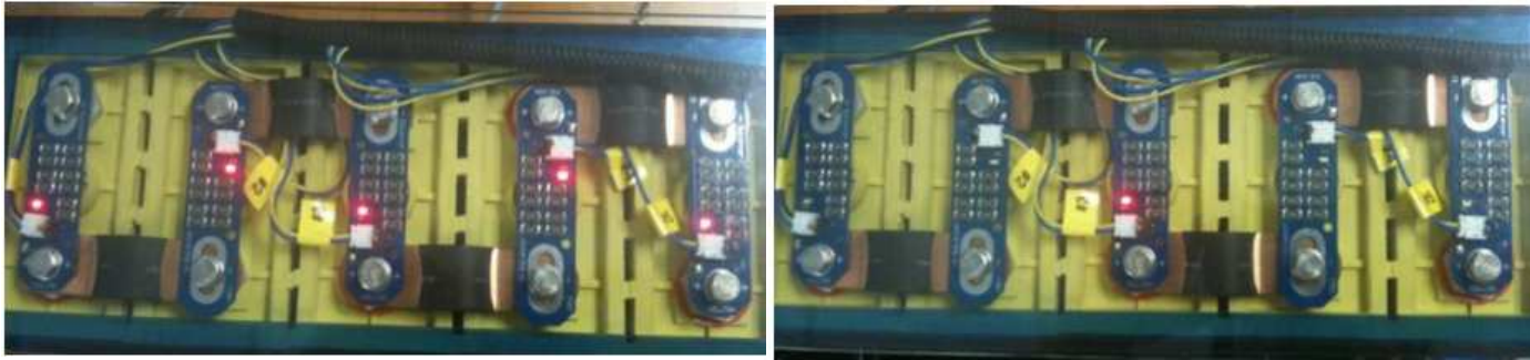
LED บนบอร์ดปรับสมดุลเซลล์ติดแสดงว่า เกิดการ Bypass กระแส
